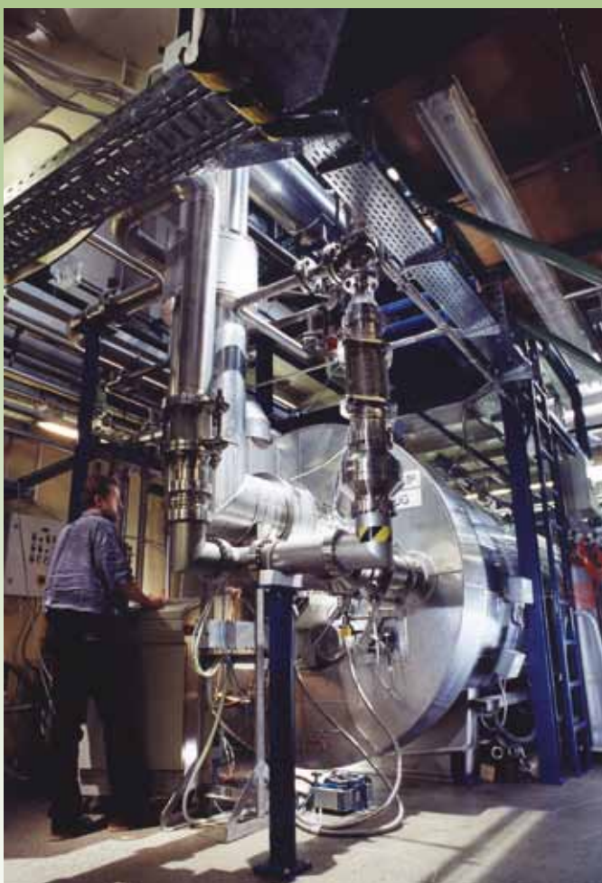
Een model voor een cryogene pomp voor ITER, getest in het Karlsruhe Instituut voor Technologie, Duitsland. Foto: Forschungszentrum Karlsruhe (FZK).
