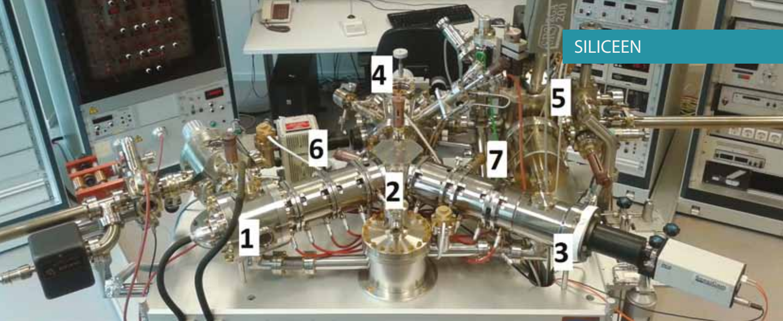
Figuur 2 De LEEM-opstelling. Elektronen worden gegenereerd door een elektronenkanon (1). De elektronen razen door een optische kolom en worden 120^\circ afgebogen door een stralingsdeler (2) richting de hoofdkamer (4) waar het monster zich bevindt. De elektronenbundel wordt dan afgeremd tot lage energieën ( \sim 1\text{-}20 eV). Na de interactie tussen laag-energetische elektronen en het monster bewegen terugverstrooide elektronen naar de stralingsdeler waar vervolgens weer een afbuiging van 120^\circ plaatsvindt. De elektronen bewegen zich voort door een optische kolom om uiteindelijk bij de detector te komen (3). Cycli van sputteren en opwarmen werden uitgevoerd in de preparatiekamer (5). Met de diafragma's (6 en 7) kan men lokale LEED-patternen en een spot selecteren voor helderveld- of donkerveld-belichting.
