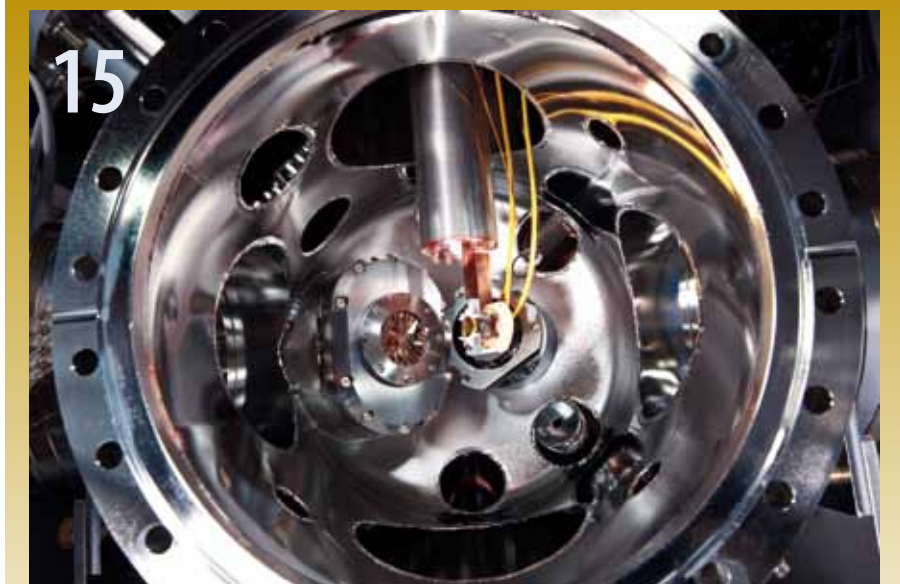
Foto van de binnenkant van de vacuümkamer van de UHV-opstelling voor het bestuderen van de verontreiniging van EUV-spiegels.
