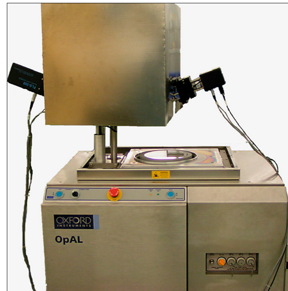
Figuur 4: De Oxford Instruments OpAL™ reactor zoals gebruik voor de depositie van \text{Al}_2\text{O}_3 door middel van zowel thermisch als plasma-geassisteerde ALD.
