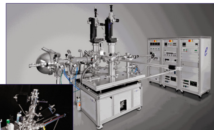
(Links) MBE-FIB systeem voor de fabricage van kleine halfgeleider structuren met ion beam milling.
