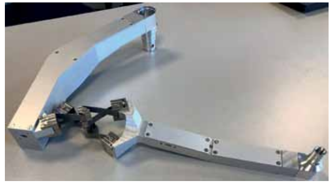
Figuur 11 Links: Assemblage van de op flexures gebaseerde robotarm. Rechts: Geproduceerde op flexures gebaseerde robotarm.
