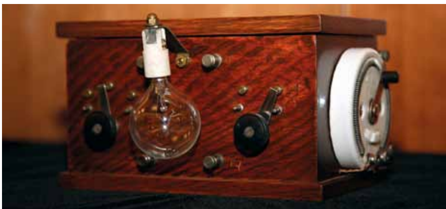
Radio-ontvanger met Audion-buis.
