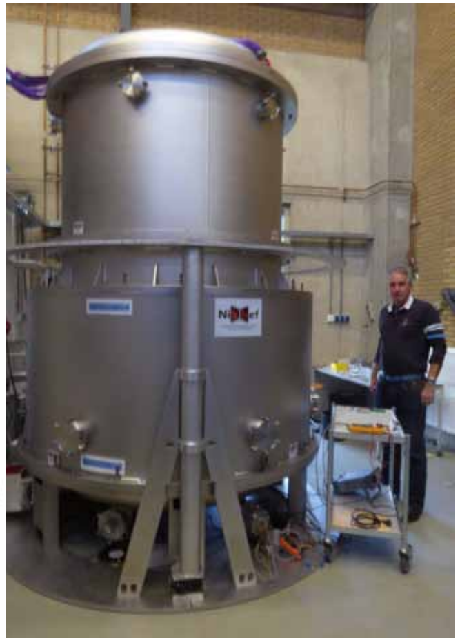
Figuur 3 Links: Schematische tekening van een antibewegingsfilter, gebruikt in Advanced Virgo. Rechts: Martin Doets bij de vacuümpostelling in het Nikhef, waarin de trillingsvrije ophanging van de optiek ontwikkeld is.
