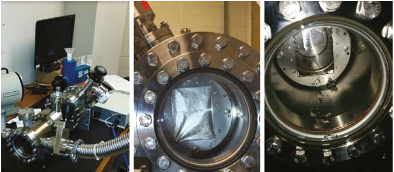
Figuur 5 Opstelling tijdens pompexperimenten van de IRVB (links). Een opbolling van het folie gedurende vacumeren (midden). Restanten van een faalttest (rechts).
