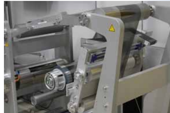
De folie in de roll-to-roll produc- tielijn loopt zodanig dat de actieve laag geen contact maakt met de machine.
