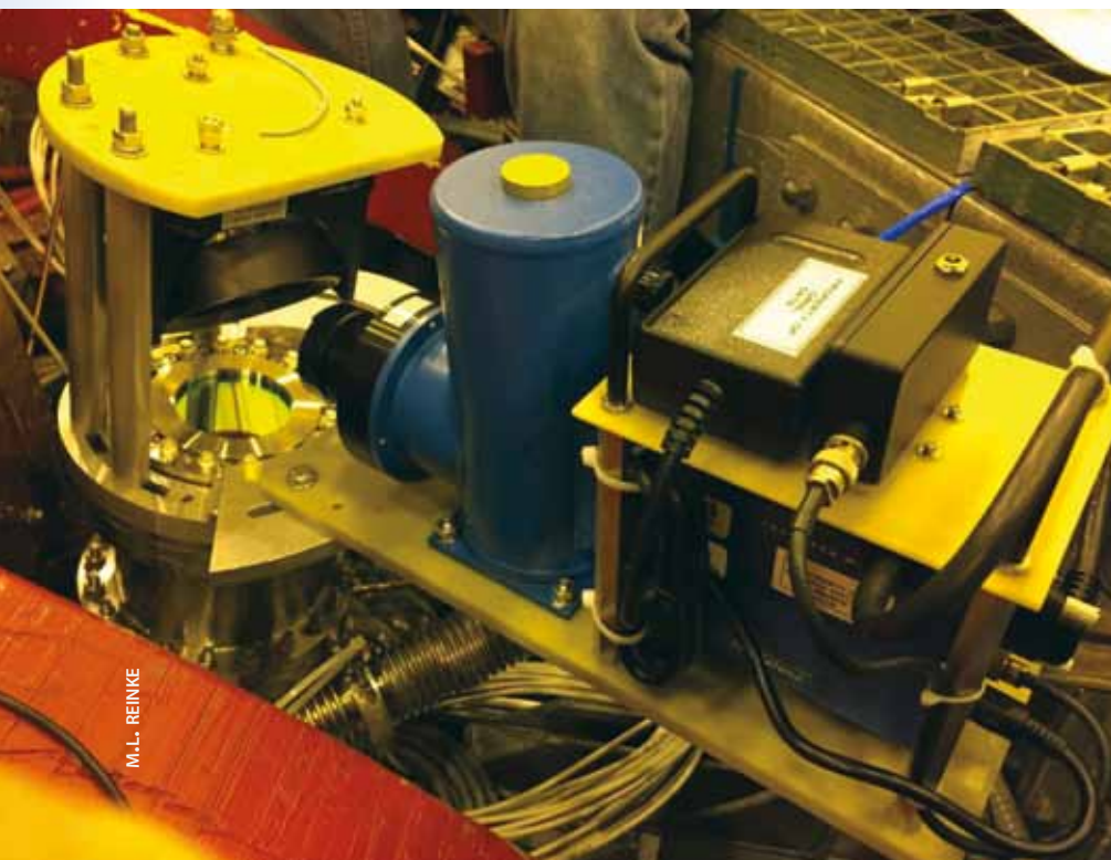
Figuur 1 De infrarood-video-bolometer geïnstalleerd op de NSTX-U. Camera, spiegel en raam zijn goed zichtbaar.
