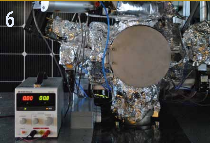
Op de voorpagina staat een foto van de ALD-opstelling die is gebruikt voor de depositie van \text{MoO}_x voor efficiëntere zonnecellen.
