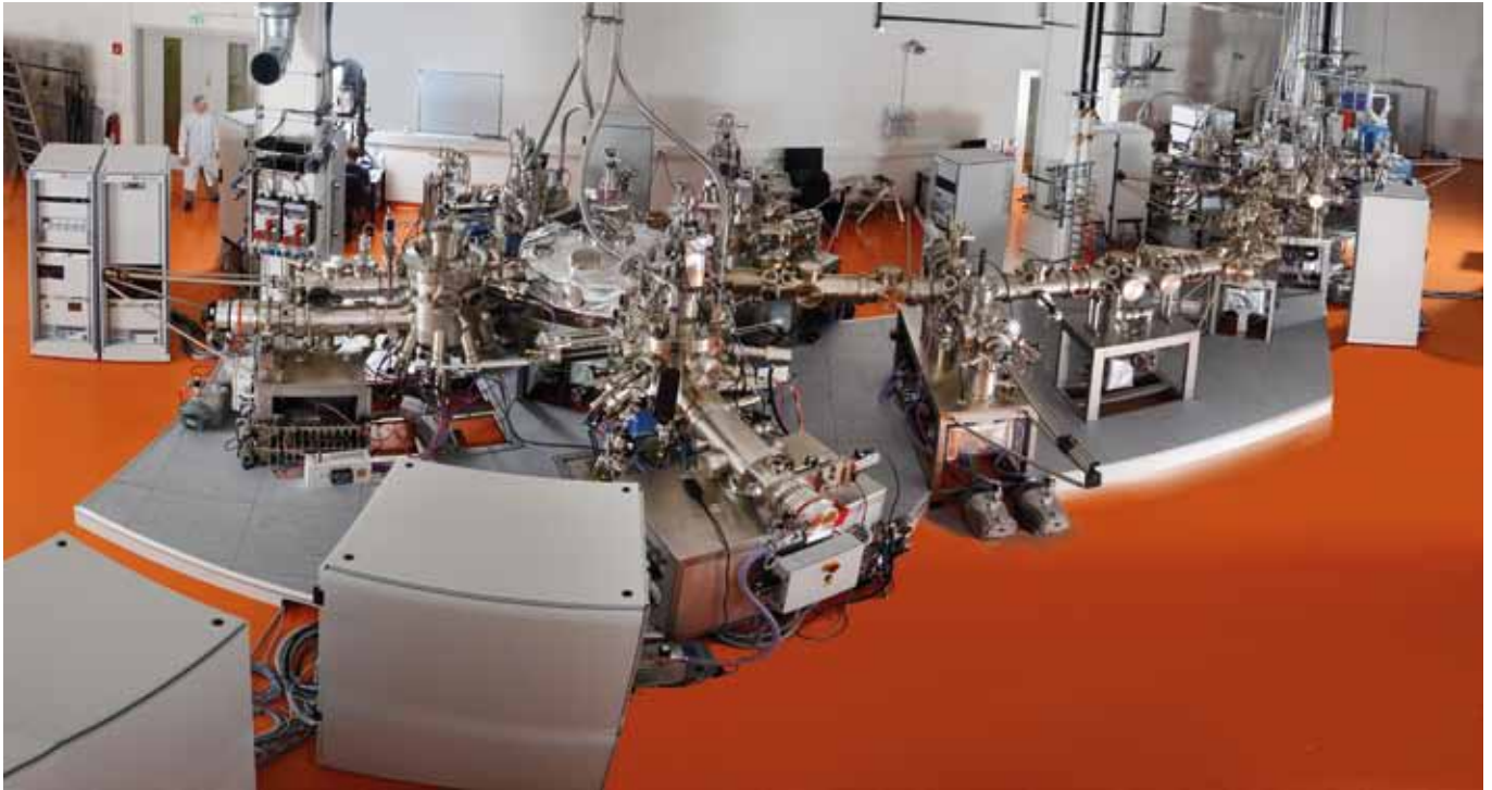
Een multitechniek UHV-systeem met dunne-filmdepositie en diverse analyseinstrumenten voor quantum-informatiematerialen.
